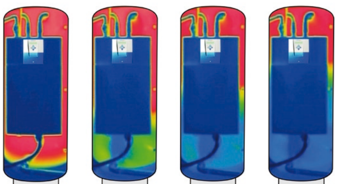
Entladung durch Frischwassererwärmer
