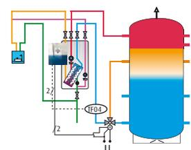
Schaltfunktionen, die wie die Solarfunktion den Fühler TF04 verwenden, sind nicht mit der Solarfunktion kombinierbar!
