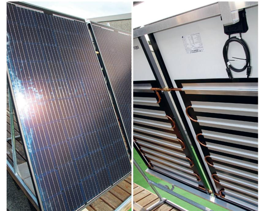
Der PV-T-Kollektor: Siliziumzellen auf der Vorderseite und ein klassischer Solarthermie-Absorber auf der Rückseite.
